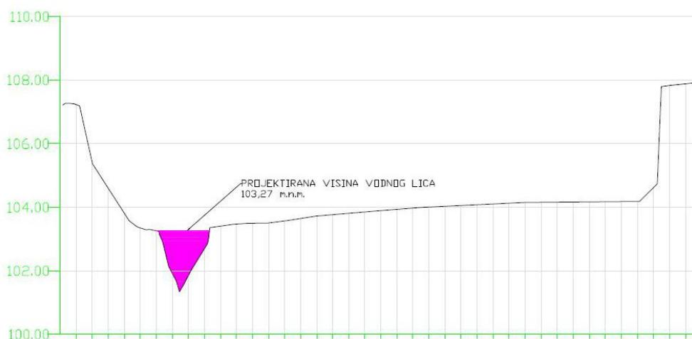
Slika 2.6 Shematski prikaz presjeka pregrade i pogled na pregradu na lokaciji varijante 2 (Izvor: Idejno rješenje)
