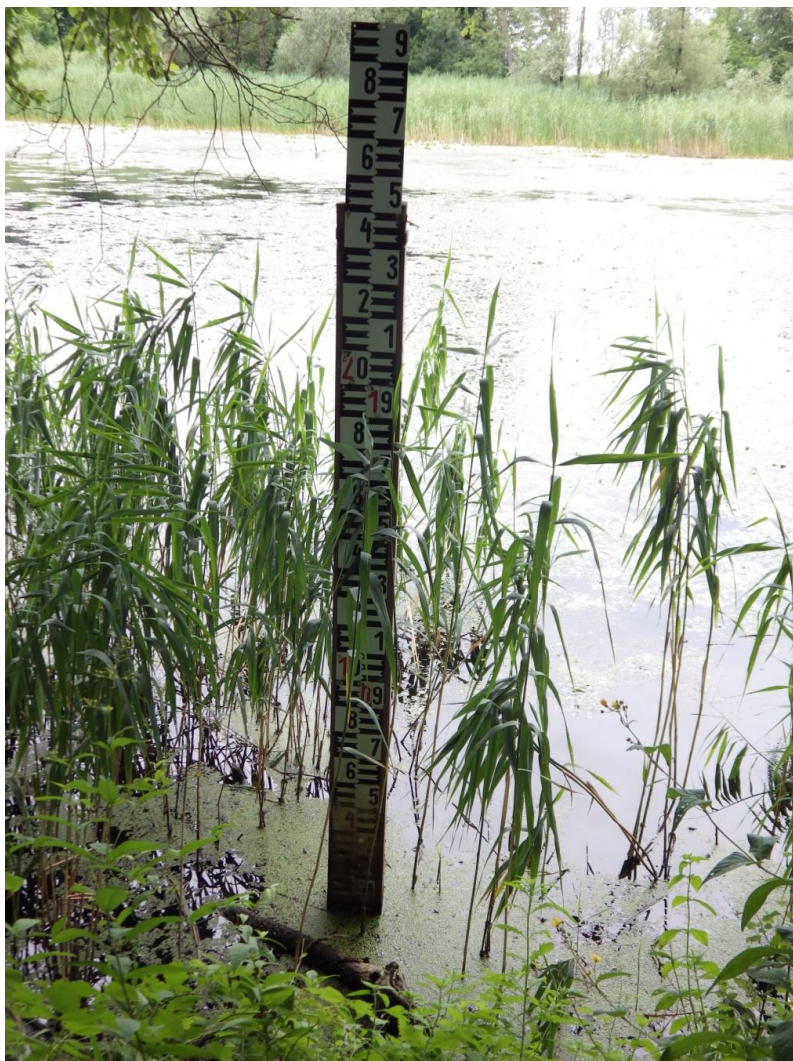
3. ábra: Vízszint mérő oszlop az Ó-Dráva alsó szakaszán 2016. július 15.-én
