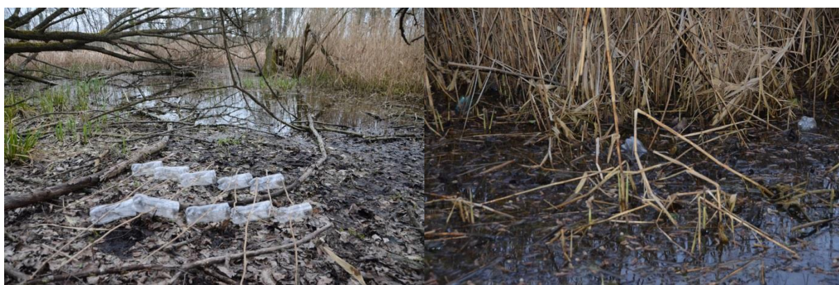
3. ábra. Kihelyezésre előkészített (bal oldali kép), majd kihelyezett (jobb oldali kép) palackcsapdák az Ó-Dráva partján 2017. március 18-án. Fontos, hogy a palackcsapdáknak (jobb oldali kép) mindig maradjon elegendő levegő (Fotók: Purger J. J.)
